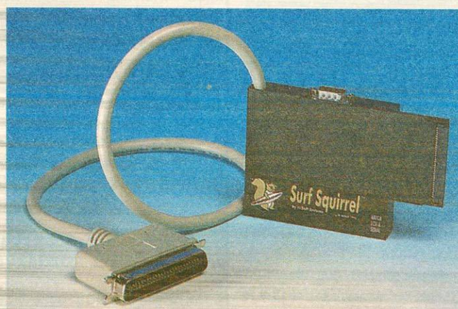
Einfacher geht's nicht: Der SCSI-Host-Adapter mit serieller Schnittstelle »Squirrel« ist einfach zu installieren
