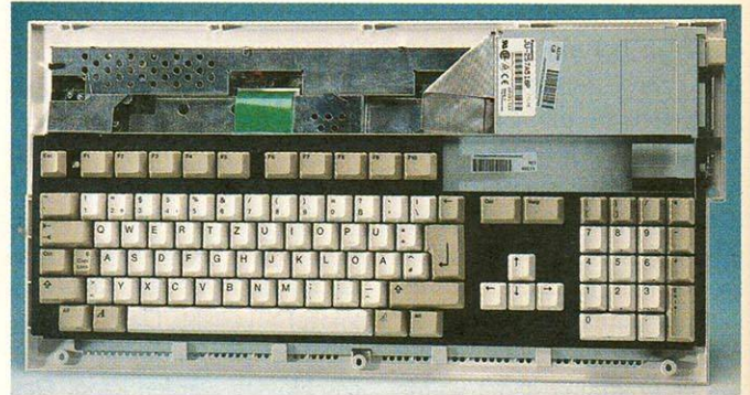
Freigelegt: Nach Abnahme des Gehäuse-Oberteils ist das Diskettenlaufwerk problemlos zugänglich
